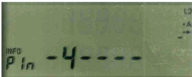
Die 1. PIN-Ziffer kann eingegeben werden. Mit jedem kurzen Tippen der Aufruftaste bzw. mittels kurzem Lichtsignal über den optischen Aufrufsensor, wird die Ziffer um 1 erhöht. Sobald die gewählte Ziffer erreicht ist, warten Sie ca. 3s.
