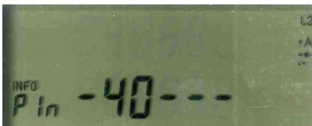
Nach der Eingabe der 4-stelligen PIN wird diese intern überprüft. Ist die PIN falsch eingegeben worden, wechselt die Anzeige wieder zur Standardanzeige. Ist die PIN korrekt, wird die Anzeige vollständig aktiviert und Sie können durch wiederholtes kurzes Tippen der Aufruftaste bzw. über ein Lichtsignal auf den optischen Aufrufsensor den Zähler bedienen und durch die Zusatzfunktionen schalten.
