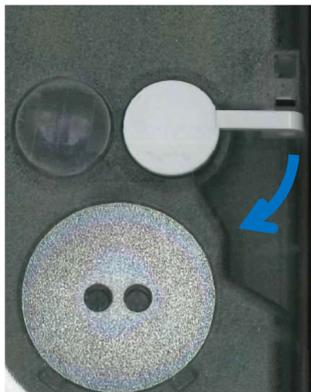
Durch das Drehen der Aufruftaste im Uhrzeigersinn, entsperren Sie diese und ermöglichen dadurch die weitere Eingabe.
